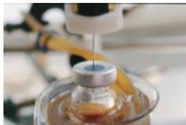
Abb. 1: Die Festphasen-Mikroextraktion (SPME) ist eine innovative Probenvorbereitungsmethode mit deren Hilfe flüchtige, wertgebende Inhaltsstoffe effizient isoliert und angereichert werden können.
