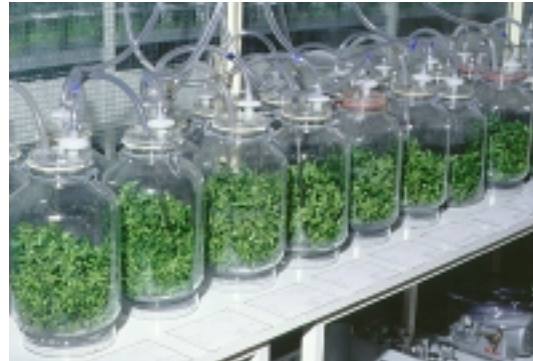
Abb. 1: Fünf-Liter-Kulturgefäße zur automatischen Versorgung von Phalaenopsis -Kulturen mit flüssigem Nährmedium
